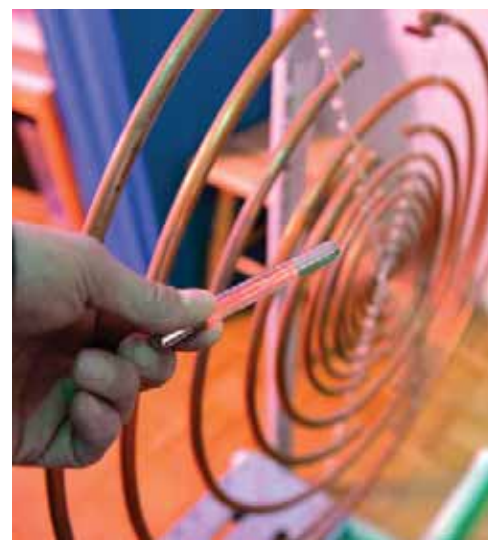
Močno elektromagnetno polje med antenama je pokazala žarnica v merilnem instrumentu, ki je posvetila.
